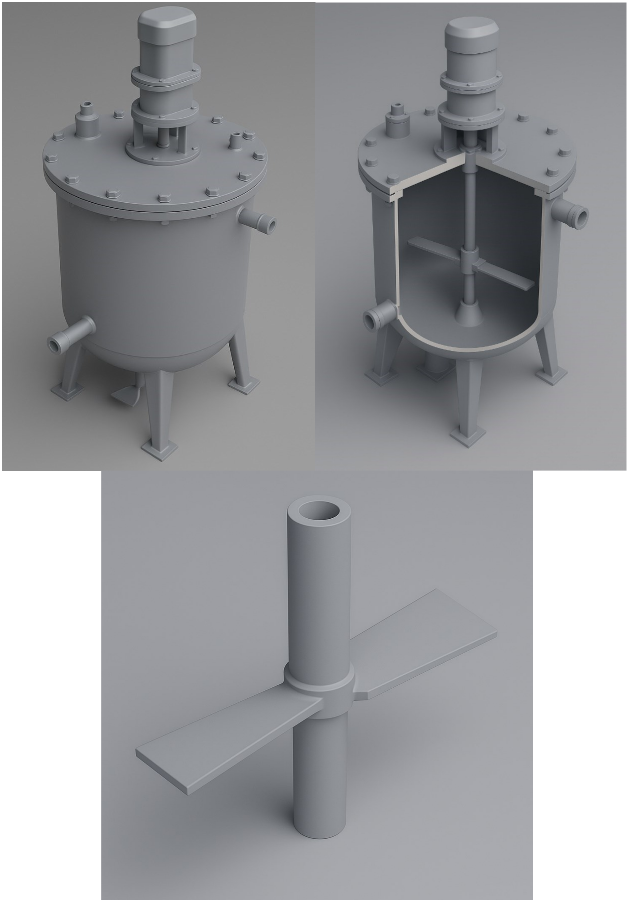
Рис. 2. – Результати 3D-моделювання реактора-змішувача в Blender.
