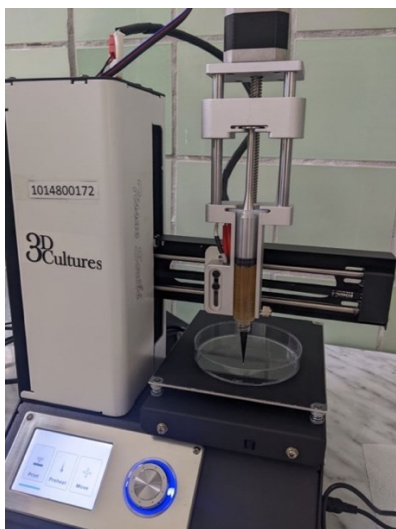
Рис. 1. Процес друку на біопринтері гідрогелем хітозану
